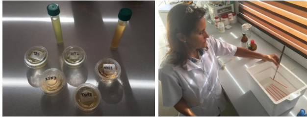
Figura 5. Criopreservación de microalgas utilizando un método simplificado. Panel izquierdo, muestras de diferentes especies de microalgas. Panel derecho, congelación en una caja de hule espuma (31 cm X 23.5 cm X 22.5 cm de grosor) la cual contenía 5 cm de nitrógeno líquido. Las microalgas se mezclaron con 10% de DMSO y se colocaron en pajillas francesas de 0.5 mL para ser luego colocadas en una rejilla la cual fue situada a 9 cm por encima del nitrógeno líquido para ser congeladas con el vapor de nitrógeno líquido por 10 min.
